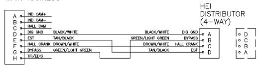
LARGE CAP HEI'S USE PINOUT SHOWN IN DASHED CONN. REQUIRES A DIFFERENT 4-WAY DISTRIBUTOR CONNECTOR. MUST ALSO SUPPLY POWER TO "BATT" TERMINAL ON CAP.
